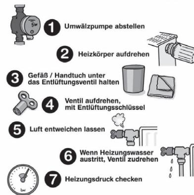
Abbildung 3: Heizung entlüften Schritt für Schritt (Bildquelle: heizsparer.de)
