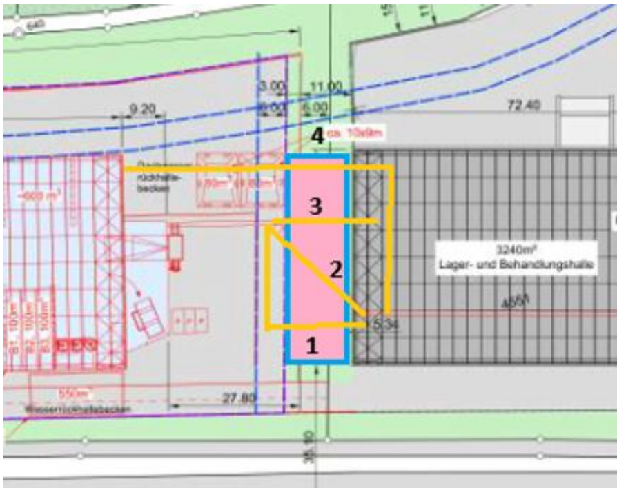
Abbildung 11 Varianten Führungen des Förderbandes
